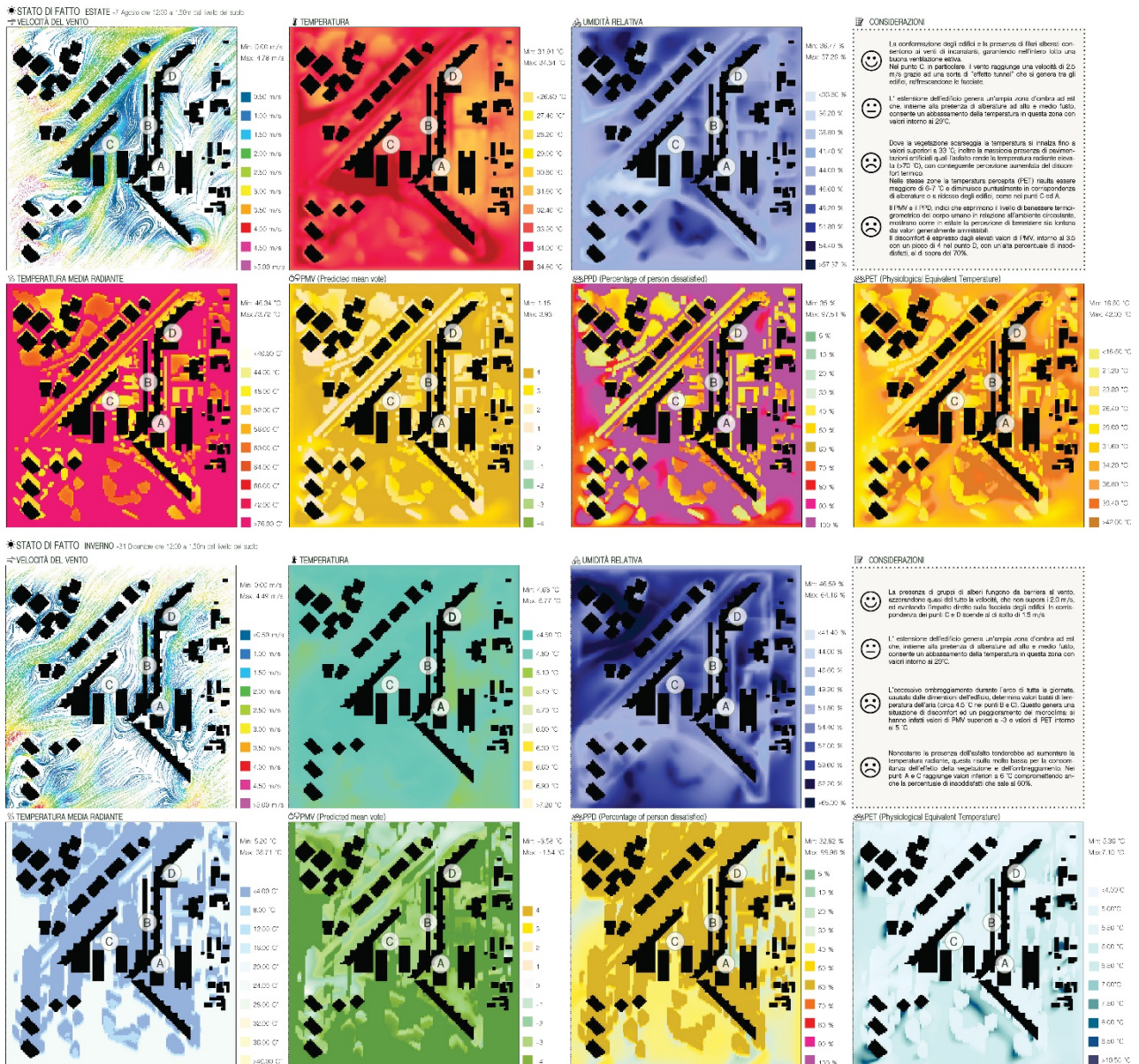
Fig. 1 Simulazioni fluidodinamiche ante-operam realizzate con il software ENVI-met.
