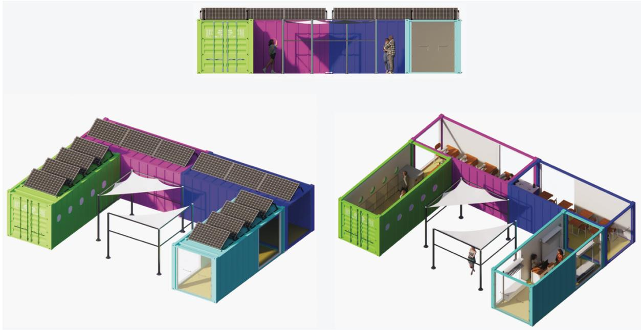
Fig. 3: Prototipo di Textile Waste Hub, con progettazione di elementi modulari per lo spazio esterno proveniente da materiale di scarto. © Sara Garmanjani; Hanieh Khorami.
