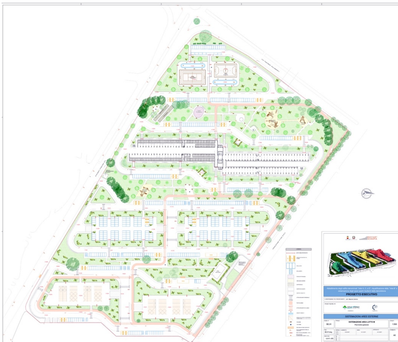
Fig. 8. Planimetria di progetto con la Vela B riqualificata e la sistemazione delle aree risultanti dalla demolizione.
