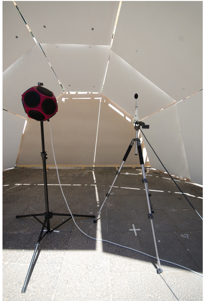
Fig. 6. Dodecaedro e microfono Ambisonic utilizzati per le misurazioni acustiche di ReS. Fonte: Ph. Sonia Ponzo.
